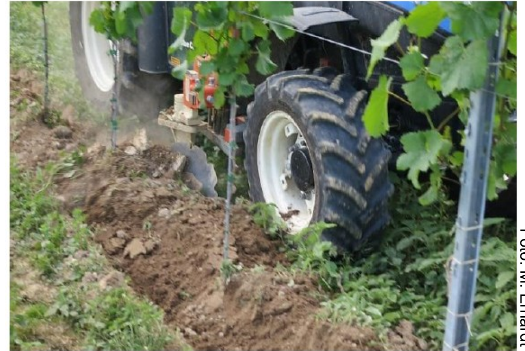
Bild 19: Der Scheibenpflug im Unterstockbereich (8 km/h schneller Einsatz).
